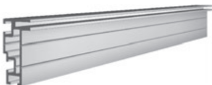
Rahmenprofil für 3mm Flach-Keder profile for frames and 3mm flat keder, 1000mm - 990g, Herstellungslänge 6100mm production length is 6100mm
